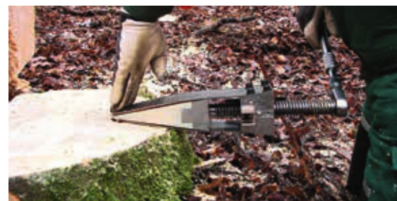
Mechanischer Fällkeil in der Seitenansicht. In der Mitte der Kunststoffkeil, der beim Vorschub über den Gewindeantrieb die untere und obere Metallplatte beim „Keilvorgang“ nach außen drückt.
