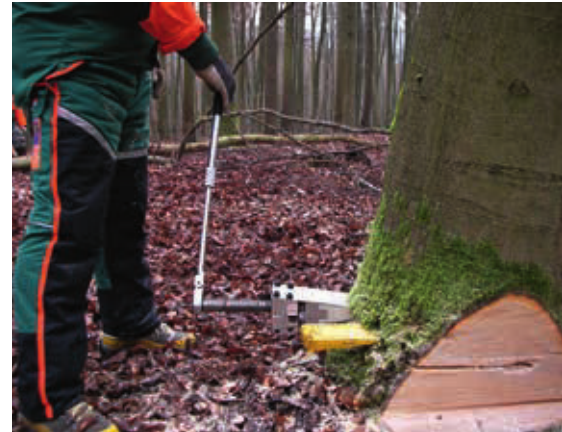
Mechanischer Fällkeil im praktischen Einsatz. Erkennbar ist die Ratsche, die durch Griffverlängerung ergonomisch bedient werden kann. Im Vergleich dazu ein herkömmlicher Plastikfällkeil.
