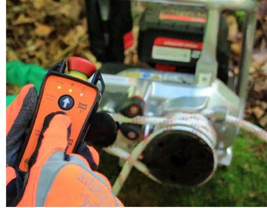
Das Zugseil wird auf die Klemmscheibe zwischen die federbewährten Scheiben gedrückt. Im Betrieb übernimmt die Fixierung die Arbeit des Gegenzuges, die bei anderen Spillwinden der Bediener leisten muss.
