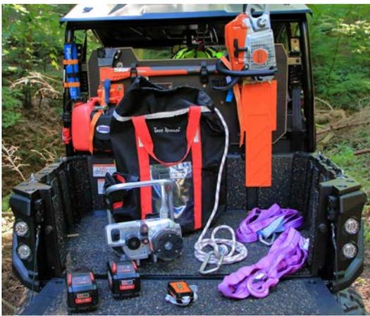
Die Testausstattung umfasste die Winde mit Fernbedienung, zwei Polyesterseilschlingen, 40 Meter Seil und zwei Akkus. Die 17,2 Kilogramm schwere Ausrüstung passt in einen Seilsack.
