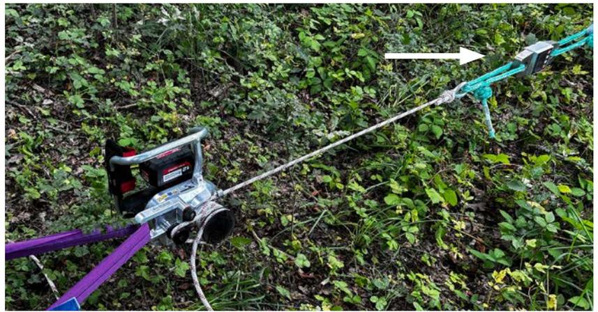
Mit einem Zugkraftmessgerät (Pfeil) stellten wir fest, dass die Winde im Kraftgang rund zehn Prozent mehr Zugleistung als die Herstellerangabe bereitstellt. Im Schnellgang sind es sogar 346 statt der angegebenen 250 Kilogramm. Die Software schützt die Winde aber dennoch vor Überlastung.
