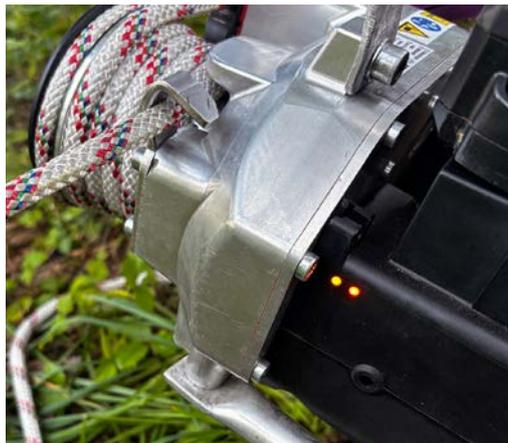
Eine LED-Leuchte blinkt, sobald der Akku eingelegt ist, die zweite, wenn die Funksteuerung mit der Winde gekoppelt wird. Erfolgt zwei Minuten lang kein Funksignal, wird die Kopplung aus Sicherheitsgründen getrennt.
