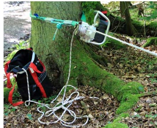
Etwas über dem Boden befestigt schwebt die Winde bei der Zugarbeit, und das Seil kann frei zu Boden fallen. So lassen sich auch längere Strecken bewältigen, ohne dass es zu Blockaden im Seilauslauf kommt.
