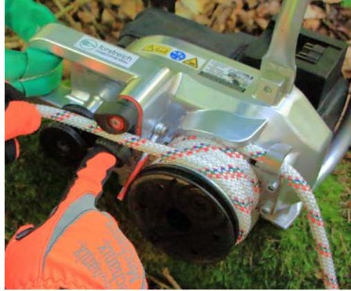
Danach wird der Seilabstreifer abgeklappt und das Zugseil durch die Rücklaufsperre und über die Umlenkrolle zurück zur Spilltrommel geführt.
