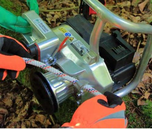
Zu Beginn der Seilmontage wird der Seilabstreifer hochgeklappt und das Zugseil in fünf Lagen auf die Spilltrommel gewickelt.
