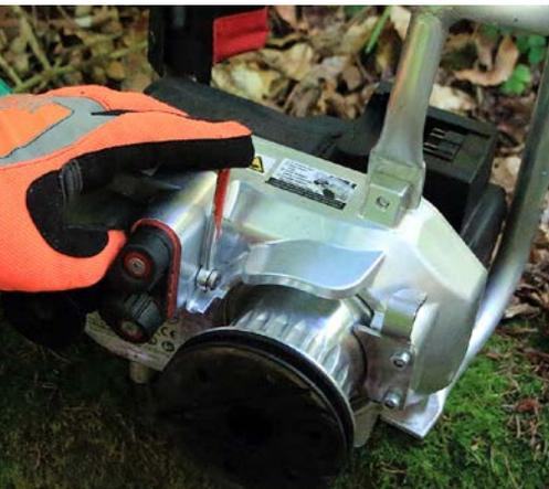
Der Seilabstreifer verhindert wirksam ein Überschlagen des Zugseiles und eine Blockade der Spilltrommel während der Zugarbeit.
